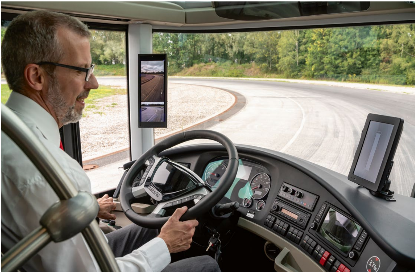
Kamera-Monitor-Systeme statt klassischer Spiegel können die Sicherheit erheblich verbessern
